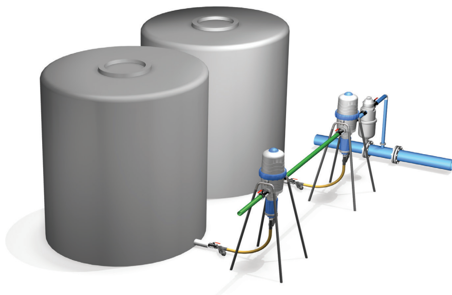
Tipica installazione doppia in linea per modelli MixRite TF
